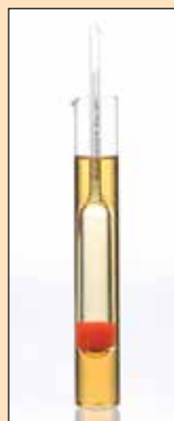
Alkoholmessgerät Glasspindel + Glaszylinder Mit diesem Messgerät kann man den Alkoholgehalt von Whisky und anderen Spirituosen messen. Dazu füllt man ein wenig Flüssigkeit in den Glaszylinder und lässt die Spindel aufschwimmen. Achtung: Nicht für Liköre geeignet!
